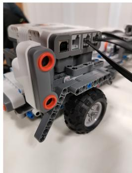
Abbildung 4. Seitlicher Ultraschallsensor
