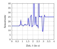
Abbildung 8. Zeitlicher Verlauf des Ultraschallsensor 3 beim Herreinfahren der Flasche in den Leergutautomaten
