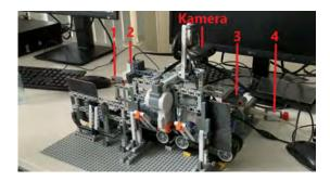
Abbildung 4. Bild von Taster, Ultraschallsensoren und Kamera
